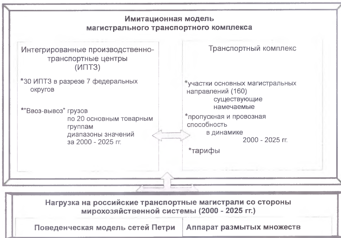
Рис.4. Структура имитационной модели магистрального транспорта и ее взаимосвязи
